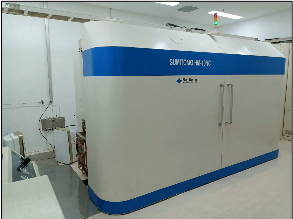
图 2-8 本项目 HM-10HC 型回旋加速器
