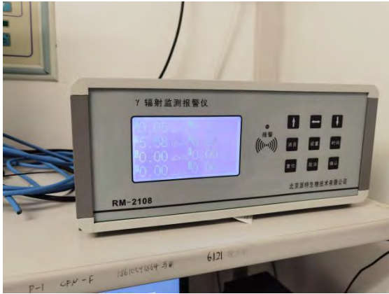
操作台上方固定式辐射报警显示器
