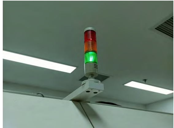
回旋加速器设备顶部三色指示灯
