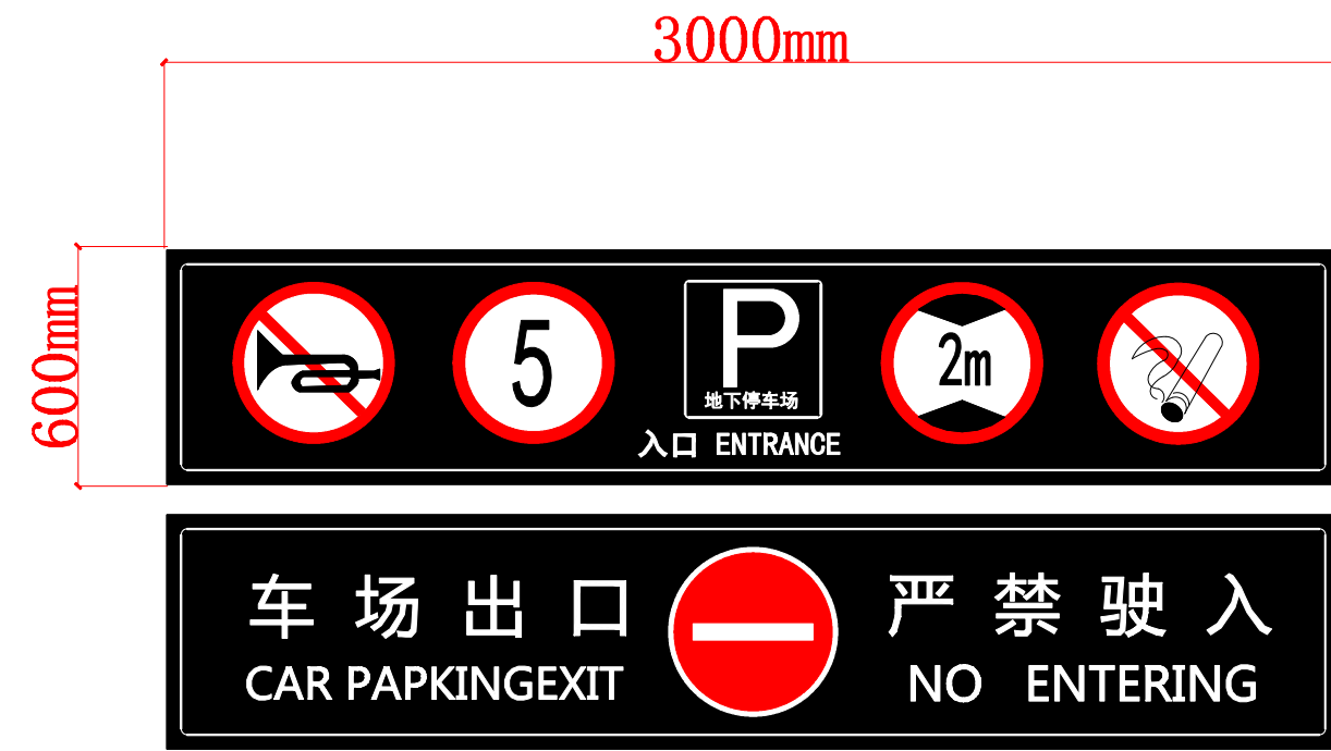
出入口门头指示牌 规格: 3000×600mm 设置作用: 设置于车库出入口位置, 相关提示、导向。
