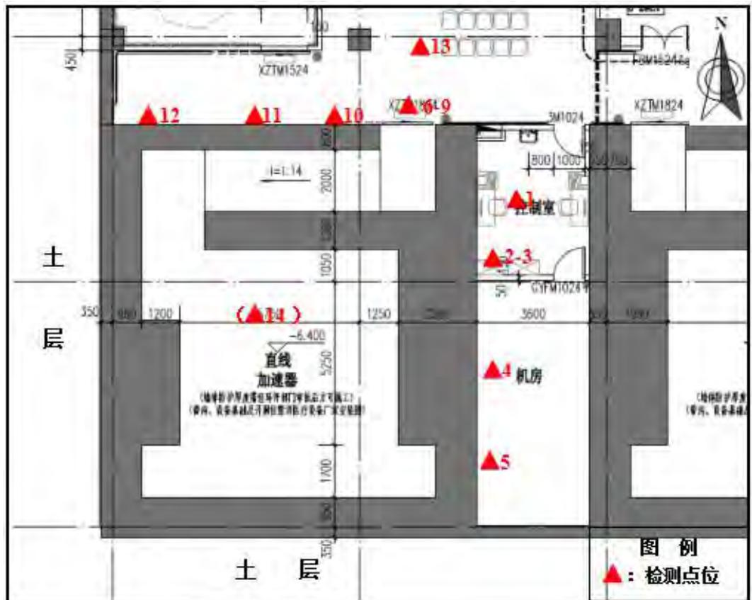
图 7-2 门诊服务中心 B1 直线加速器机房防护效果检测点位示意图
