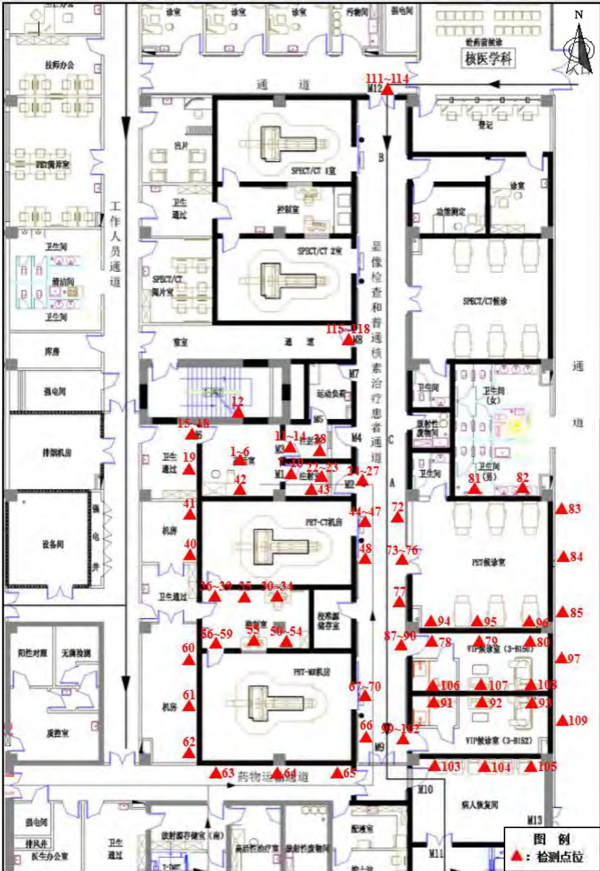
图 7-7 使用  $^{18}\text{F}$  药物工作场所辐射检测点位示意图
