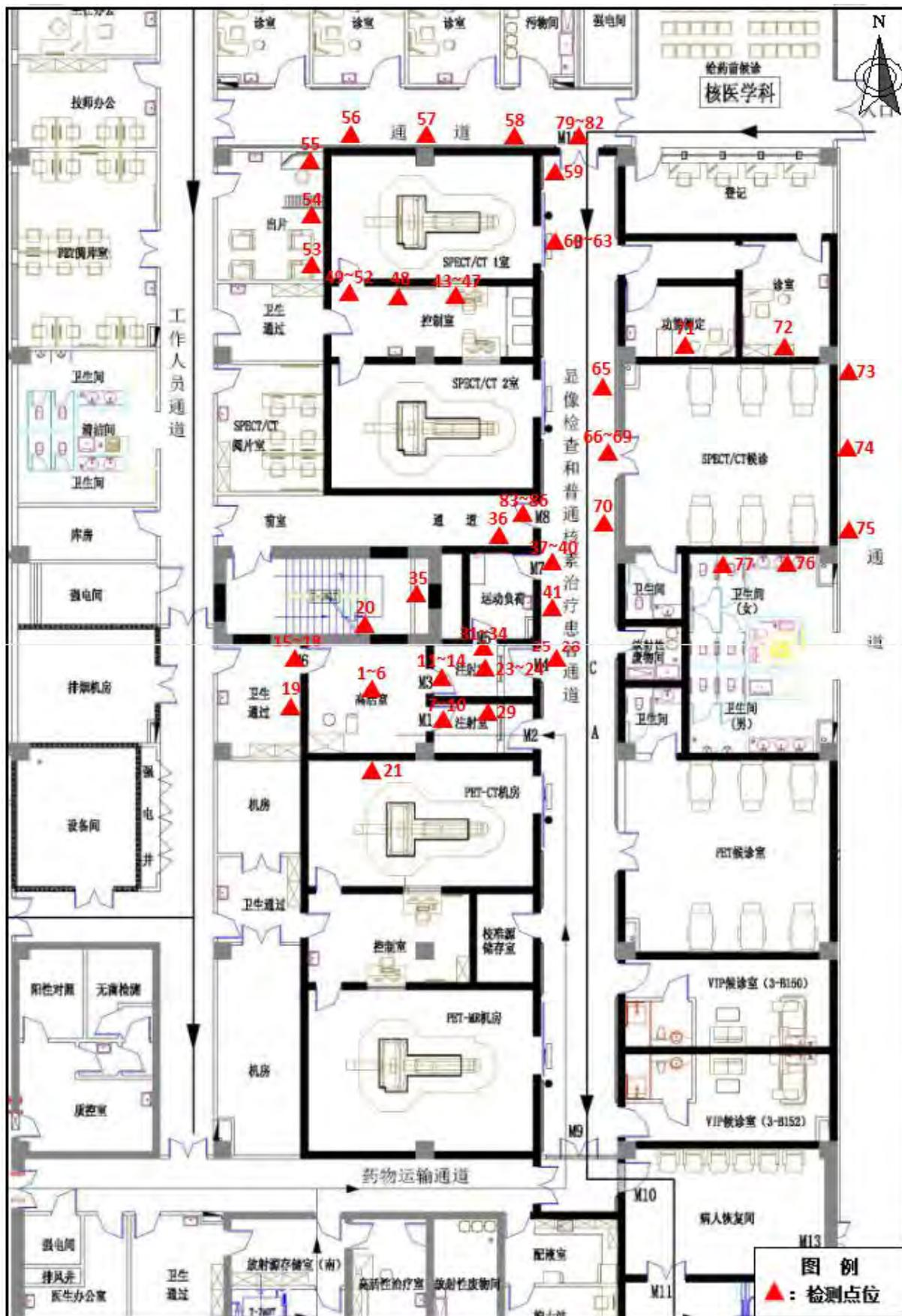
图 7-8 使用  $^{99m}\text{Tc}$  药物工作场所辐射检测点位示意图
