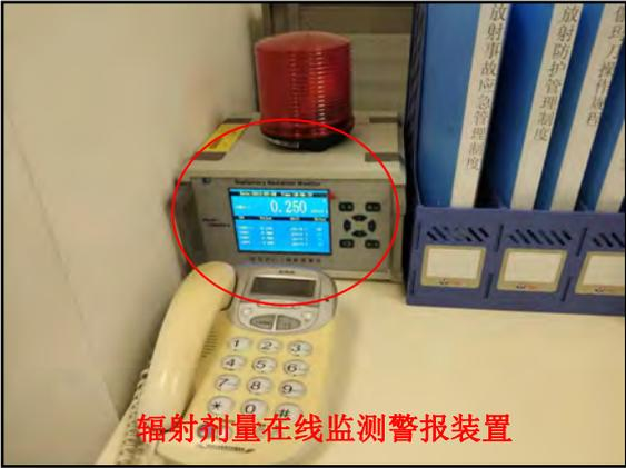
辐射剂量在线监测报警装置
